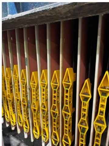
Figura 13: Ánodos con rigidizadores en rack (Imagen propia, 2025)
