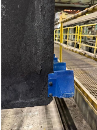
Figura 12: Ánodo con aislador anódico tipo delta (Imagen propia, 2025)
