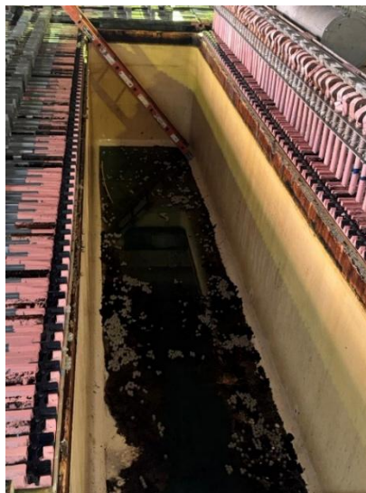
Figura 68: Desborre de celda con borra anódica en su interior (Imagen propia, 2025)
