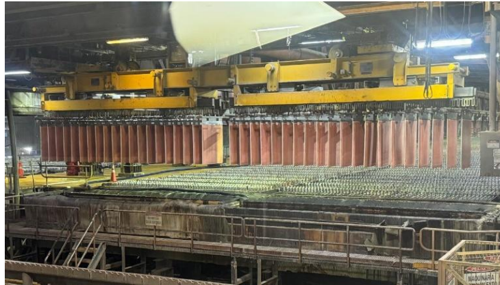
Figura 63: Lingada de cátodos previo ingreso a cuba de lavado (Imagen propia, 2025)
