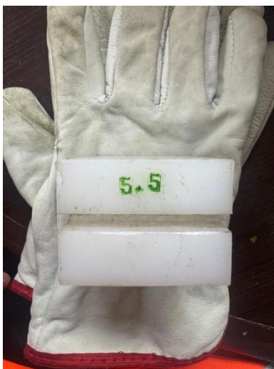
Figura 67: Herramienta para medición espesor de ánodo (Imagen propia, 2025)
