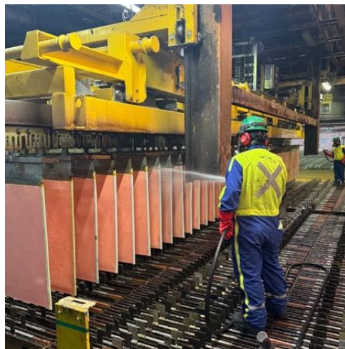
Figura 64: Lavado de cátodos con agua a presión (Imagen propia, 2025)
