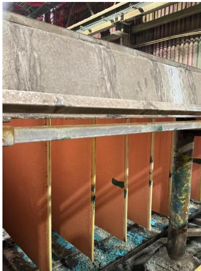
Figura 65: Cátodo pintado por rechazo físico en inspección de lingada (Imagen propia, 2025)
