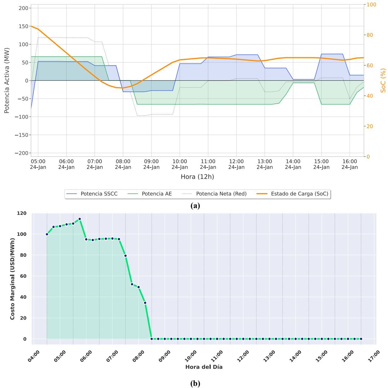
Fig. 4.15 Operación Detallada y CM en Ventana de 12 h — HIB 67/33 (24-ene) (a) potencia SCCC, potencia AE, potencia neta hacia la red y SoC entre 05:00 y 16:00; (b) CM horario del mismo intervalo.
