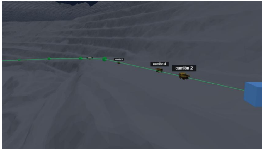
Figura 20 Circulación de camiones sobre la ruta de transporte definida en la topografía de referencia
