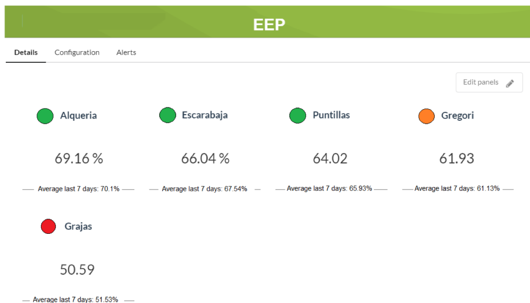
Figura 2. Visualización de la eficiencia de bombeo del día anterior y la media de los últimos siete días. (López-Morales et al. , 2021)
