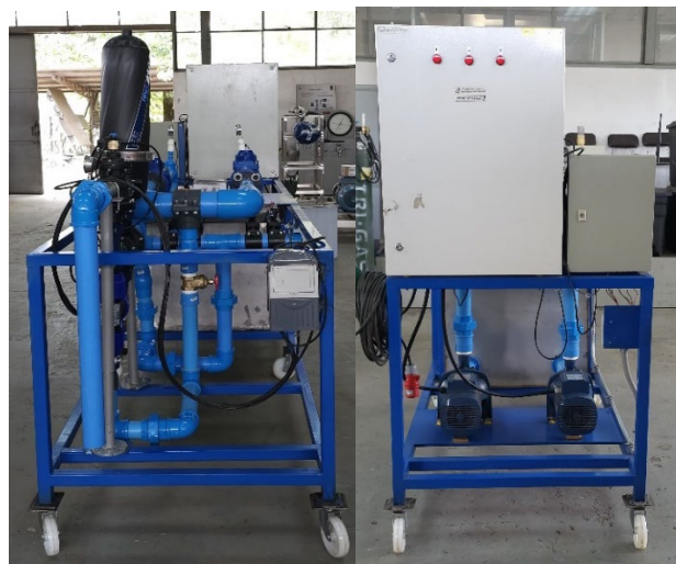
Figura 29. Vista trasera y frontal del sistema de bombeo construido.
