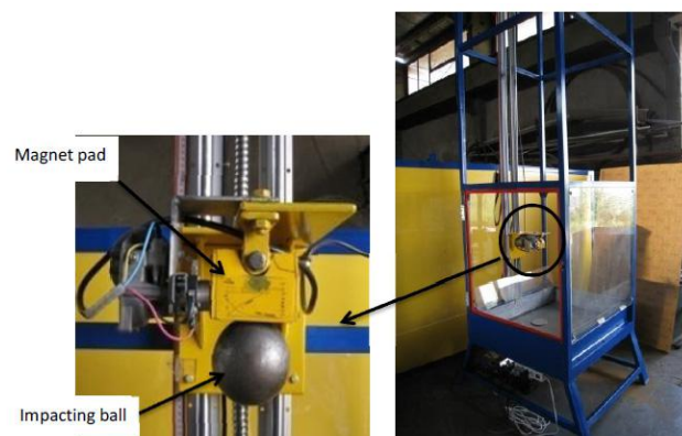
Figura 1.1 Máquina Drop Weight Test (derecha) y esfera de acero y placa magnética [8].
