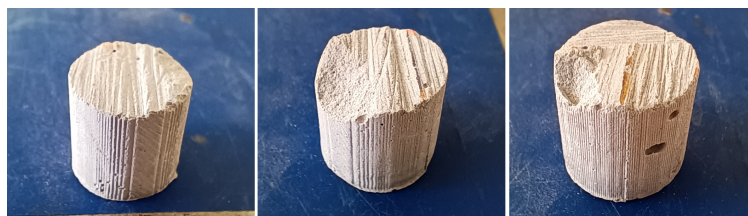
Figura 2.11 Probetas de cemento: Buena (izq.), descartada por una muesca (medio) y con burbujas (der.)
