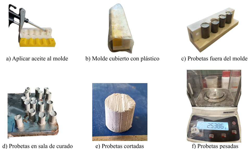
Figura 2.10 Procedimiento de preparación probetas de cemento.
