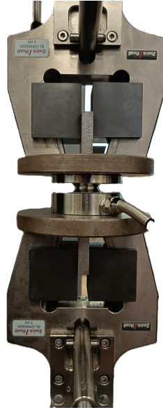
Figura 2.7 Celda de carga montada en Máquina de compresión Zwick Roell modelo Z005.
