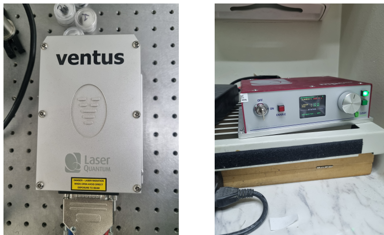
Figura 3.1.3: Imágenes de el láser (izquierda), y su controlador (derecha) utilizados en el montaje
