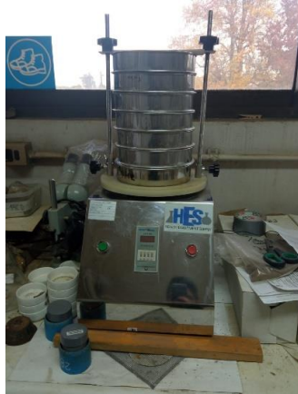
Figura 2. Agitador mecánico con tamices de diferentes medidas. Fuente: Elaboración propia.
