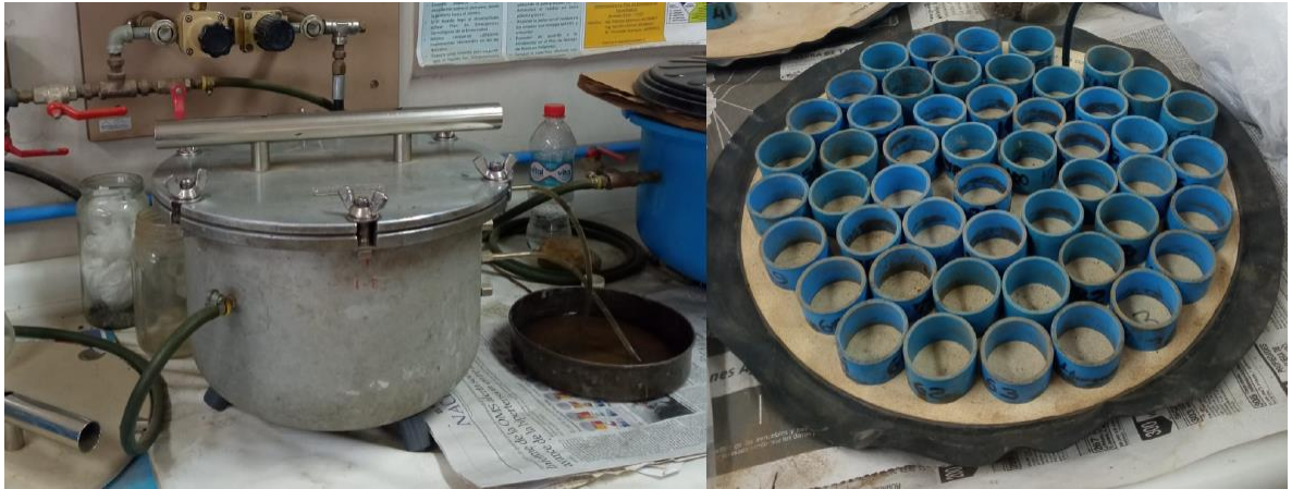
Figura 3. Olla a presión y platos de succión. Fuente: Elaboración propia.
