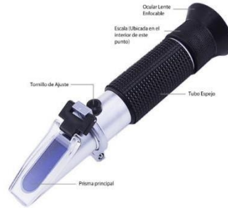
Figura 5. Refractómetro y sus partes (Extraído: TP- Laboratorio Químico, 2021)
