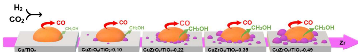
Figura 4.7. Representación gráfica del efecto del promotor de Zr en la superficie de catalizadores Cu/TiO 2 . Gris: soporte TiO 2 , naranja: nanopartículas de Cu, morado: nanopartículas de ZrO 2 .
