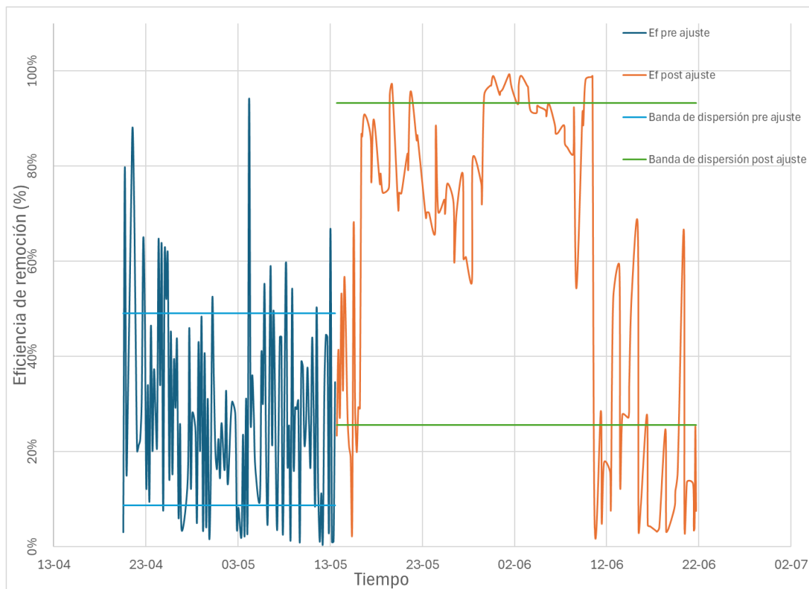
Figura 13: Comparación de la eficiencia de remoción vs. tiempo para los escenarios pre y post-ajuste.
