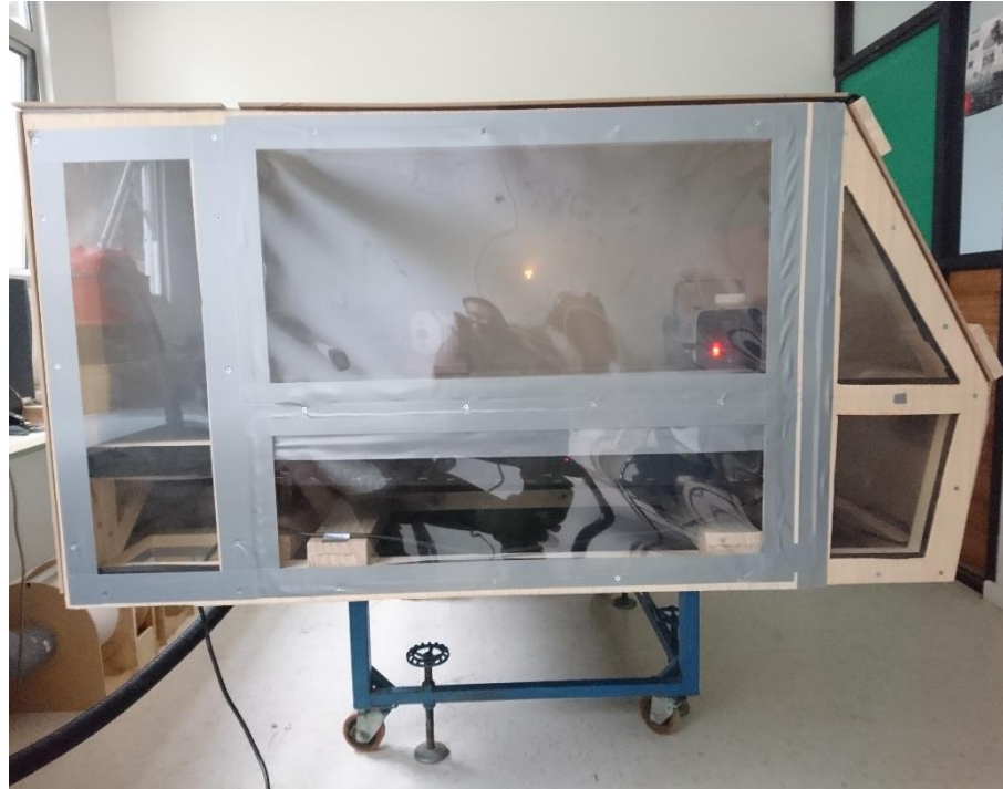
Figura 43: Prueba de saturación con humo al interior de la carcasa
