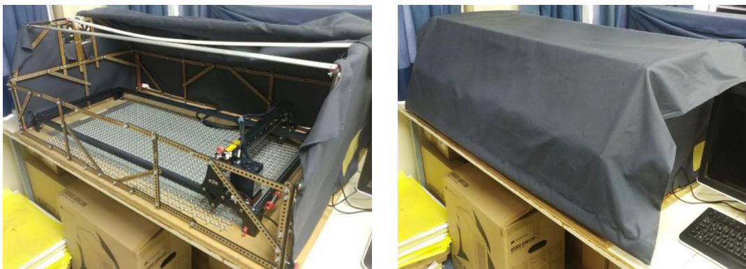
Figura 9: Configuración de carcasa y sistema de contención de gases para máquinas de corte por láser ubicadas en la Facultad de Arquitectura, Universidad de Concepción
