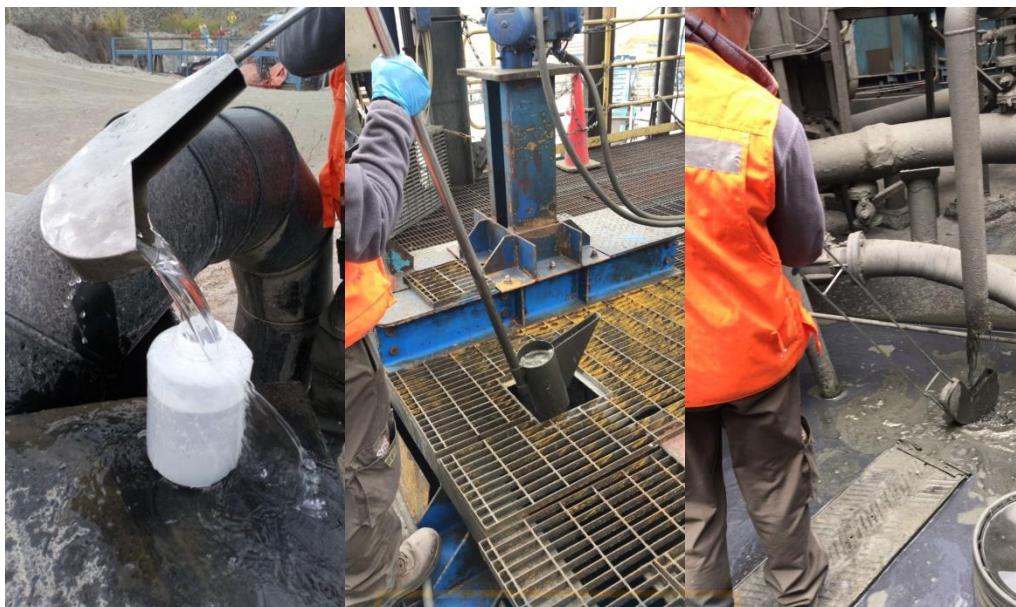
Figura 52 B. a) cortador de muestra manual b) Muestreo concentrado colectivo c) Muestreo alimentación compuesta
