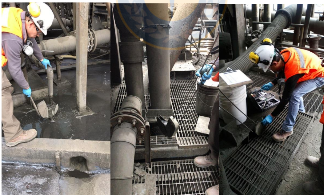
Figura 53 B. a) Muestreo cola siemens b) Muestreo cola de primera limpieza c) Medición en terreno pH/ORP cola primera limpieza
