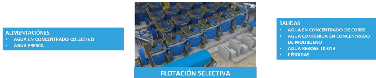
Figura 23. "Diagrama General de Agua, Flotación selectiva".
