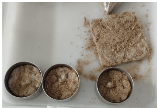
Figura A17.1: Primeras espumas formadas con bicomponente PLA/PLA.
