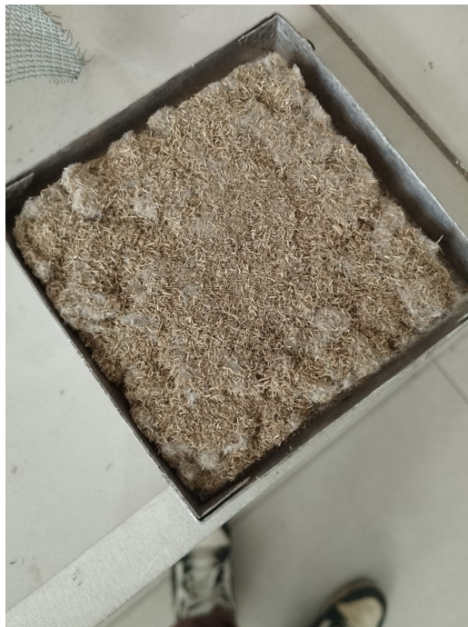
Figura A15.2: Manto formado mediante técnica de cardado manual.
