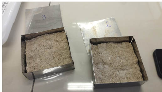
Figura A16.1: Primeras espumas formadas con el bicomponente PLA/PBS.
