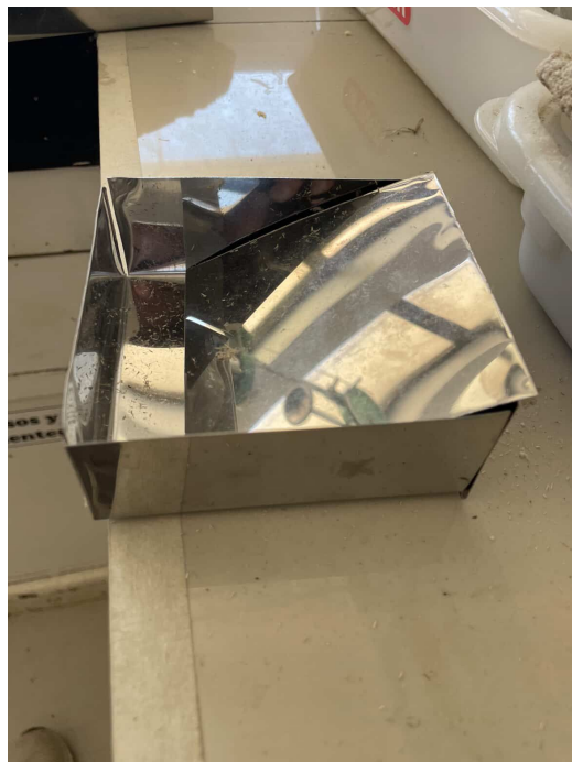
Figura A9.1: Molde realizado para hacer muestras de área 10x10
