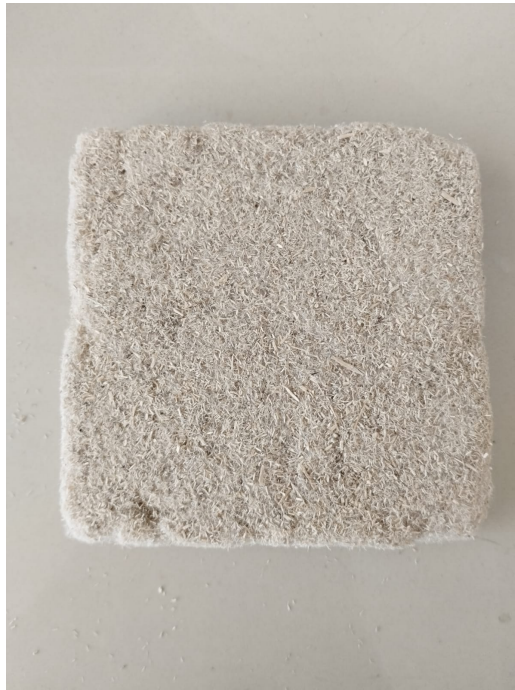
Figura A15.1: Manto formado mediante técnica de inyección de aire.
