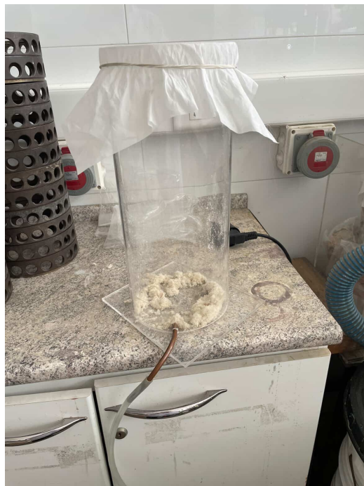
Figura A5.1: sistema utilizado para mezclar PLA/PBS con fluff
