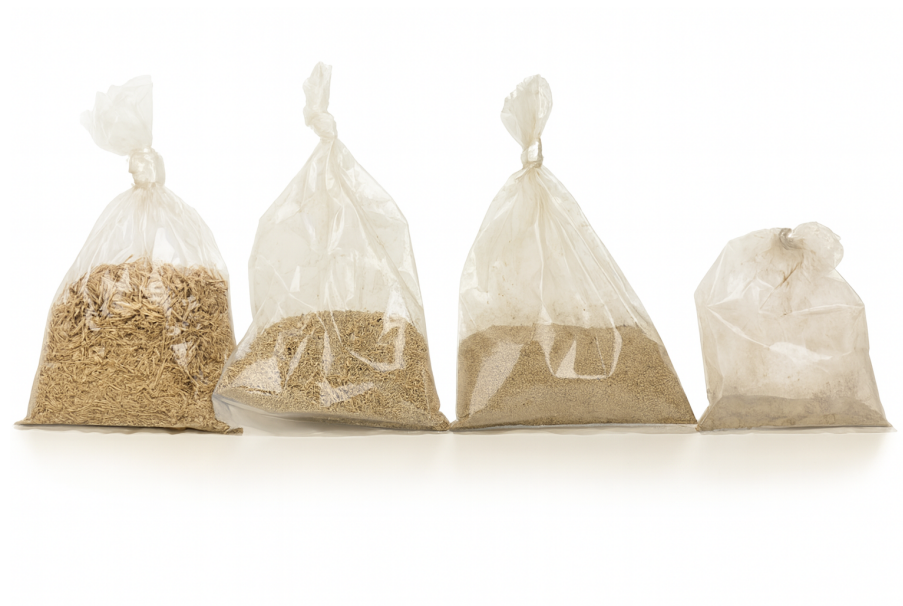
Figura A13.1: Fracciones de pulpa mecánica obtenidas mediante tamizado (muestras 1 a 4 de izquierda a derecha).
