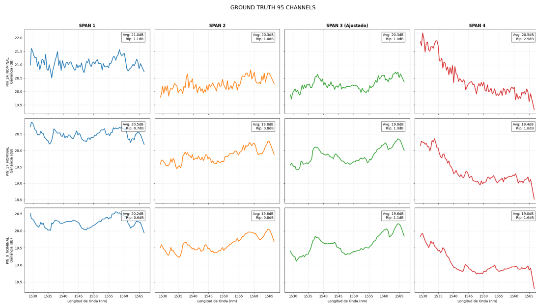
Figura 5.1.18: Perfil de ganancia experimental para el escenario de Carga Completa (95 Canales) . Se muestran las curvas de los cuatro amplificadores de la cascada (S1, S2, S3, S4).
