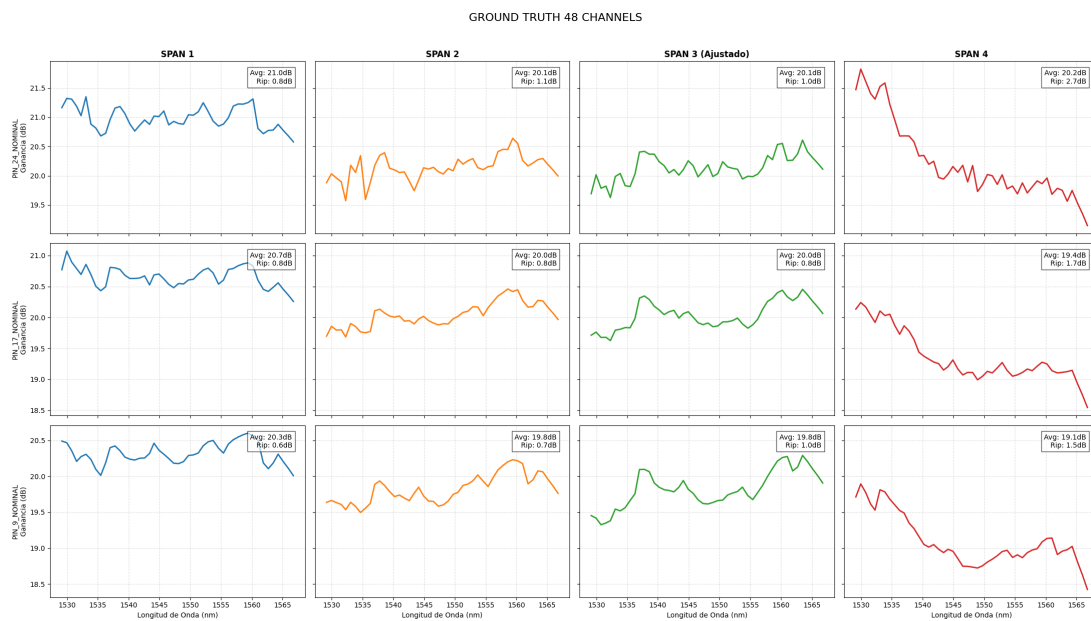
Figura 5.1.19: Perfil de ganancia experimental para el escenario de Carga Media (48 Canales) . Se muestran las curvas de los cuatro amplificadores de la cascada (S1, S2, S3, S4).
