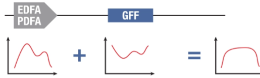
Figura 4.3.2: Filtro que establece la casi la misma ganancia del amplificador en la banda C
