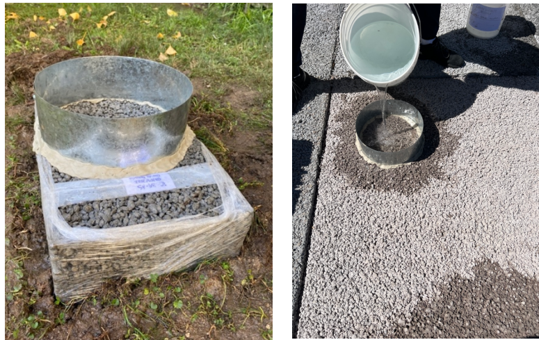
Figura 3.11 Medición infiltración (ASTM C1701): (a) Infiltración loseta (b) Infiltración en pavimento
