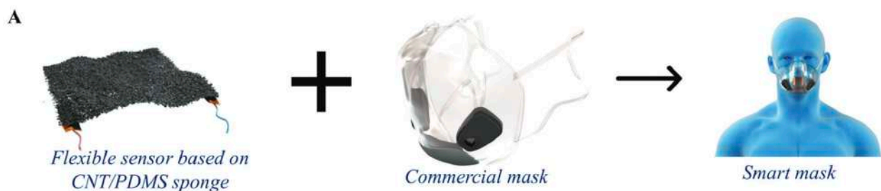
Fig. 3.5: Mascarilla inteligente compuesta por mascarilla comercial con sensor de ondas sonoras en estructura de esponja de nanocompuestos [29].
