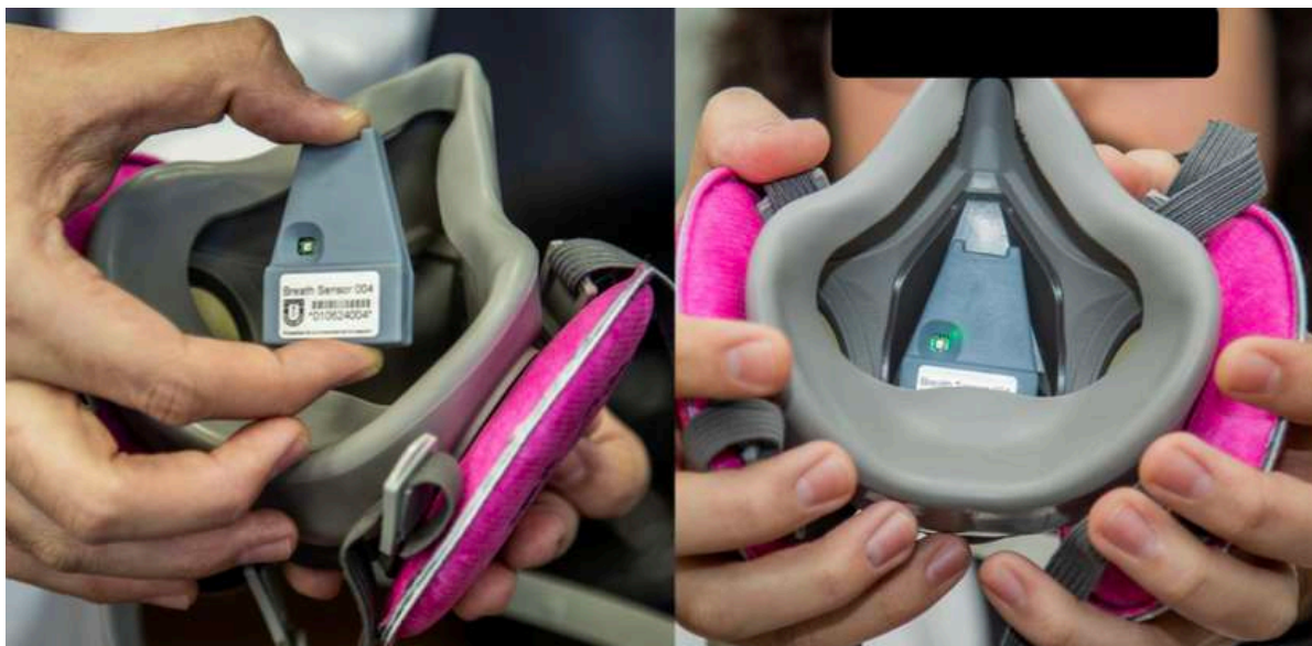
Fig. 4.3: Vista del sensor respiratorio desarrollado por Aqueveque [31], ubicado en un respirador industrial. Este dispositivo fue utilizado para registrar en tiempo real variables fisiológicas como presión, temperatura y humedad durante las pruebas.
