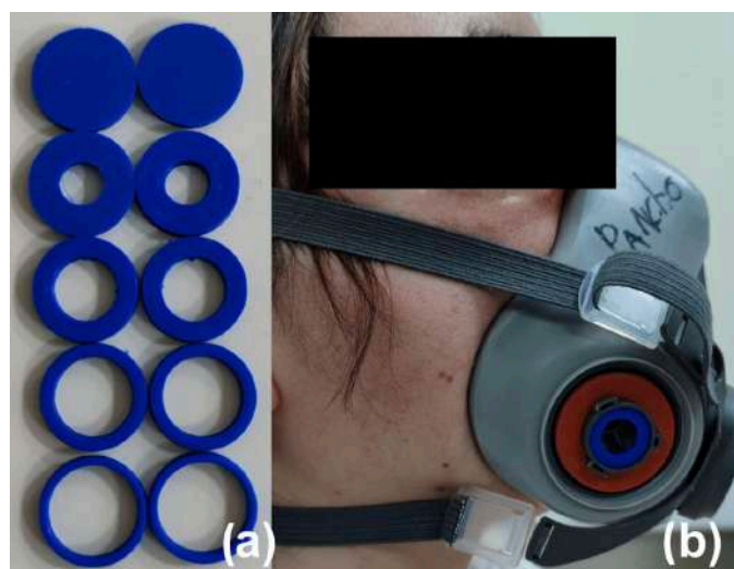
Fig. 3.8: Obstrucción de respiradores industriales utilizando piezas plásticas de diferentes tamaño [31].
