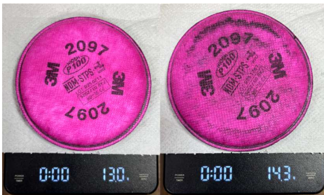
Fig. 5.4: Comparación del peso de un filtro 3M 2097 P100 antes (izquierda) y después (derecha) de la prueba de exposición prolongada a contaminantes. Se observa un incremento de masa asociado a la acumulación de partículas en el filtro.
