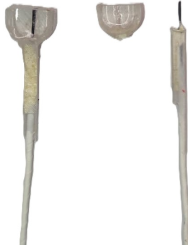
Figura 4.2 Comparación visual de una probeta FBPO antes y después del ensayo, evidenciando el despegue interfacial y la extracción parcial de la hebra.
