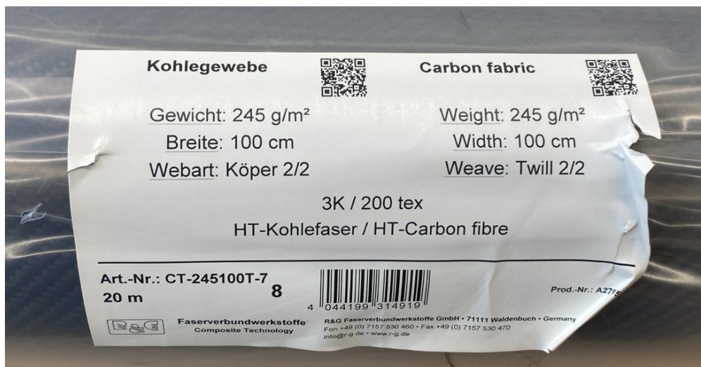
Figura 3.2 Etiqueta técnica del tejido de fibra de carbono HT 3k / 200 tex.
