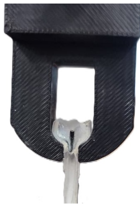
Figura 4.1 Probeta durante el ensayo FBPO, mostrando la hebra de fibra de carbono parcialmente embebida en la matriz polimérica.
