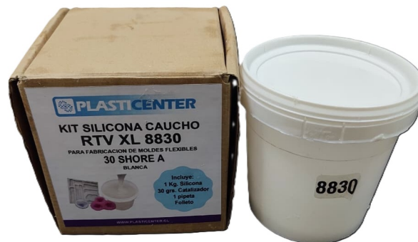
Figura 3.4 Sistema de silicona RTV empleado para la fabricación del molde blando (dureza nominal \sim Shore A 30, kit silicona y catalizador).
