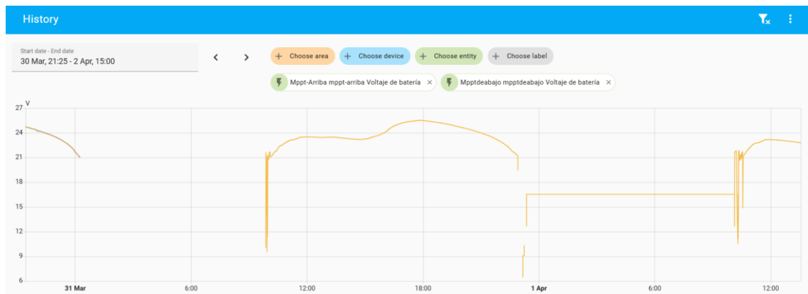
Figura 6.15 Comportamiento de tensión del BESS durante dos días
