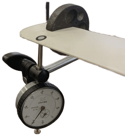
Figura 4.8 Registro experimental de la deflexión del reloj comparador con masa de prueba referencial.
