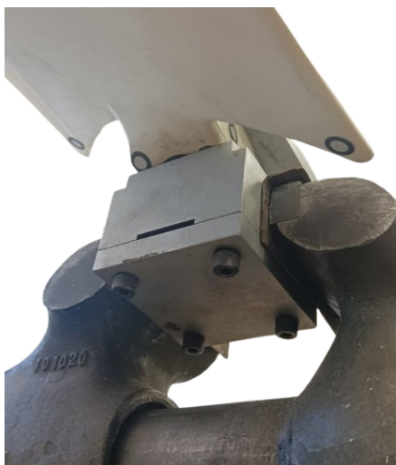
Figura 4.6 Banco de ensayos - Vista inferior del empotramiento.
