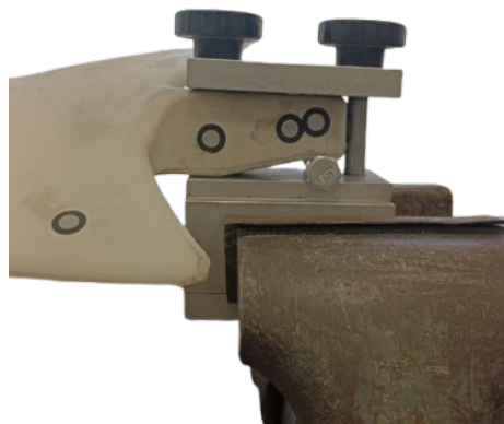
Figura 4.5 Banco de ensayos - Vista lateral del empotramiento.
