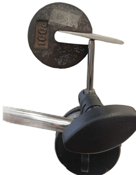
Figura 4.9 Montaje del reloj comparador en la punta de la pala con disco referencial de prueba.
