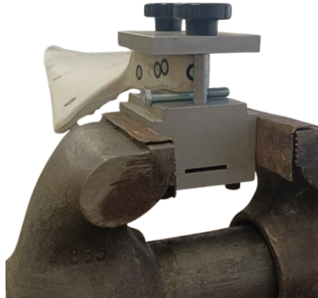
Figura 4.4 Banco de ensayos - Vista trasera del empotramiento.
