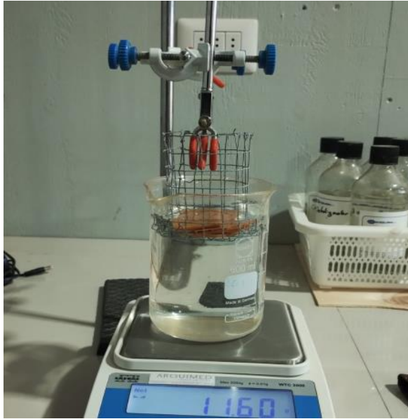
Figura 10. Ilustración del método de inmersión en agua aplicado en chapas.
