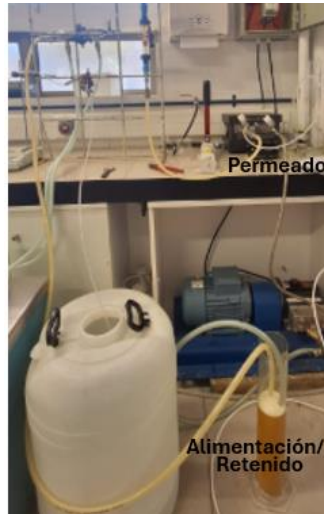
Figura 7.5. Montaje experimental del sistema de filtración tangencial con celda SEPA
