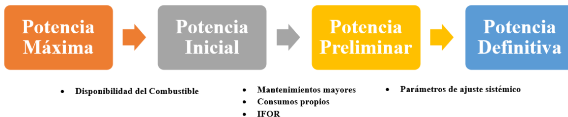
Figura E-1. Proceso de cálculo de la potencia definitiva. Fuente: elaboración propia.
