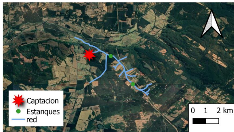
Figura 2.7 Disposición actual red agua potable
