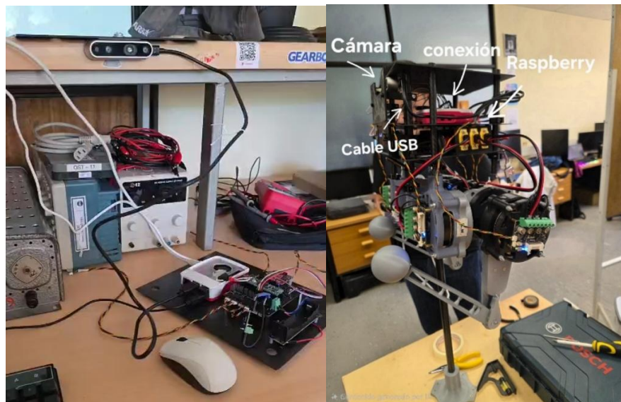
Figura 3.4: Conexión Física entre la Cámara y la Raspberry
