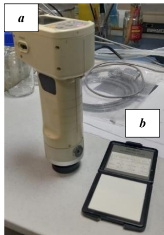
Figura 7.26: Equipo experimental utilizado para las mediciones de color del oleogel. Colorímetro Konica Minolta CR-400 (a) y placa calibradora (b).
