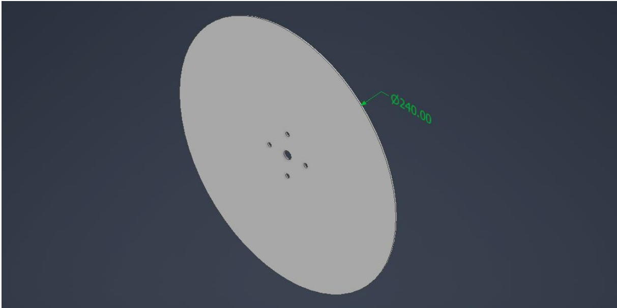
Figura 13: Modelo 3D del disco de frenado (Fuente: elaboración propia).
