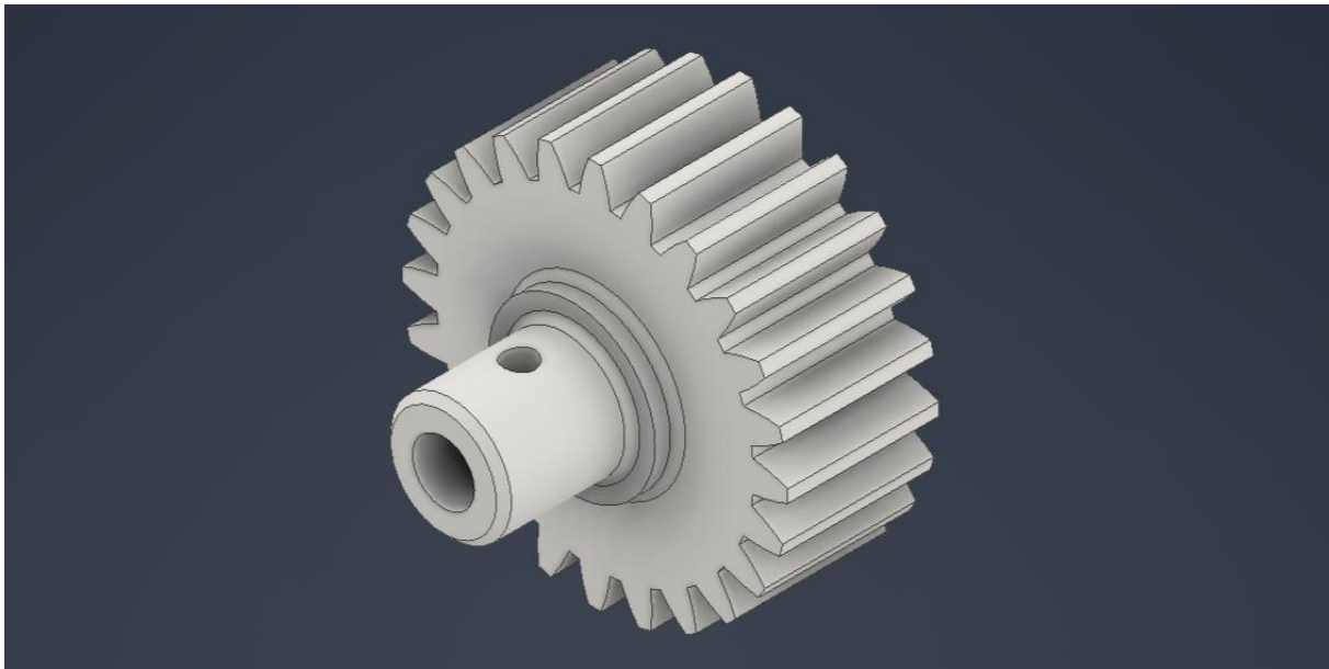
Figura 21: Modelo 3D del engranaje sol del sistema planetario (Fuente: elaboración propia).
