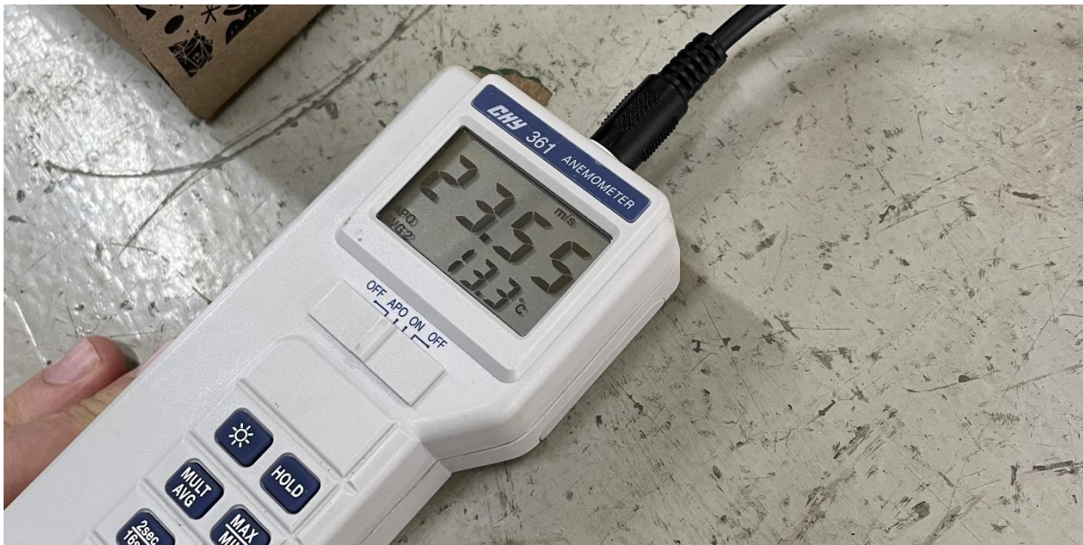
Figura 44: Anemómetro (Fuente: elaboración propia).
