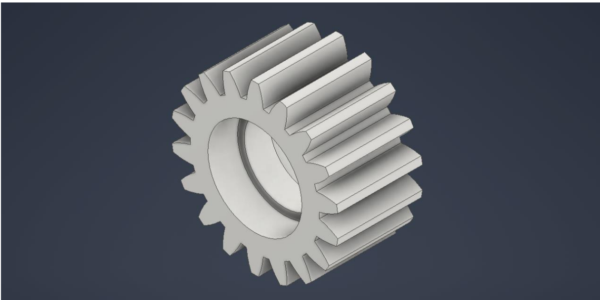
Figura 22: Modelo 3D de engranaje planeta del sistema planetario (Fuente: elaboración propia).
