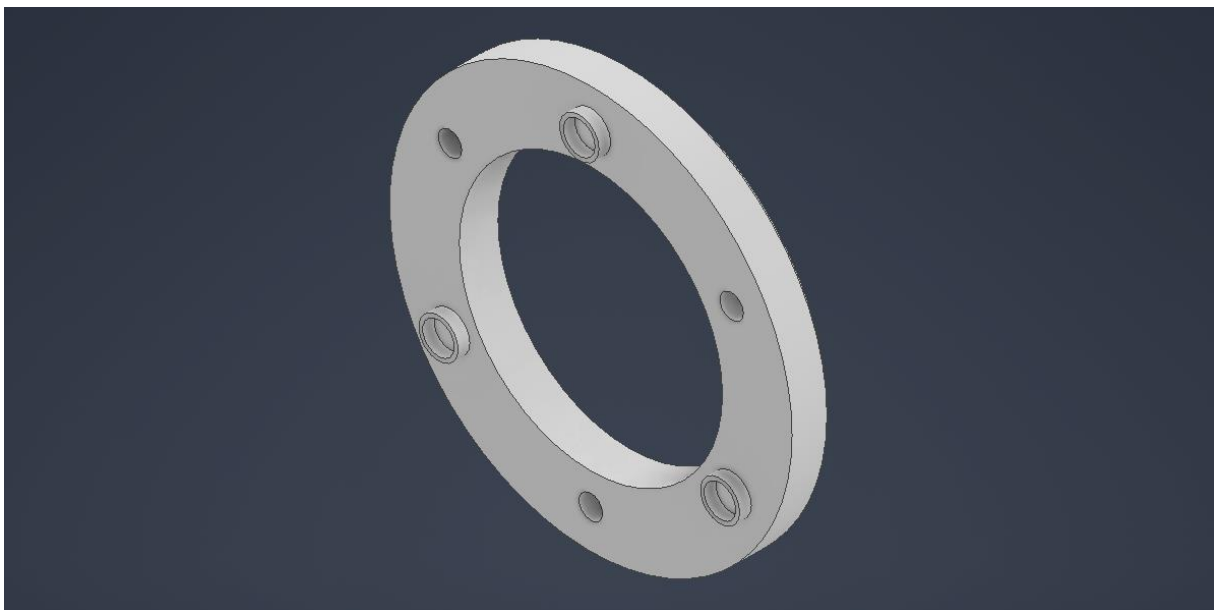
Figura 24: Modelo 3D de la tapa del porta-planetas del sistema planetario (Fuente: elaboración propia).
