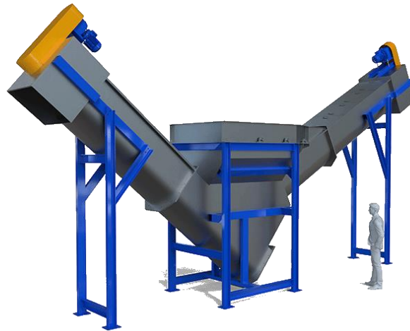
Figura 7.5 Estanque de flotación de Rotajet Recycling.
