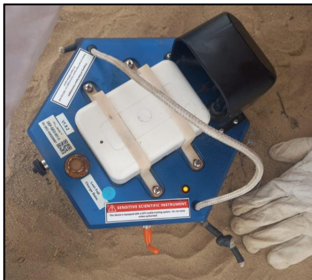
Figura 5.3: Geode instalado en terreno. Orientada hacia el norte y con la luz LED encendida.
