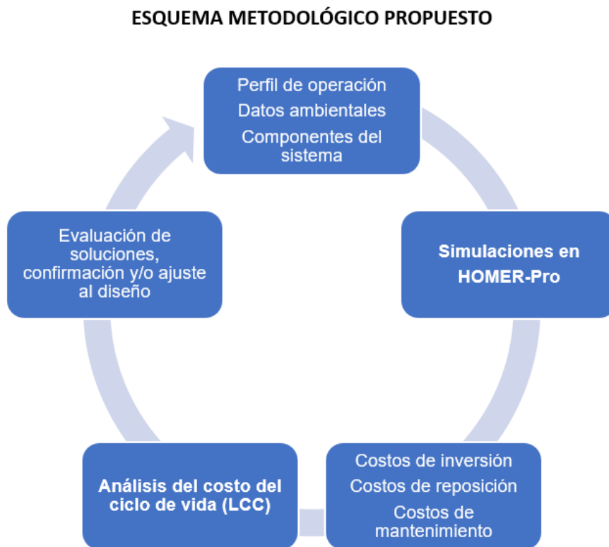
Figura 11 – Esquema metodológico de evaluación del desempeño técnico-económico de sistemas híbridos off-grid para desalinización. Fuente: Elaboración propia.
