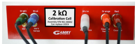
Figura 35 Imagen referencial de placa de calibración [29]
