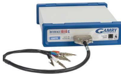
Figura 5 - Imagen referencial de potenciostato modelo Interface 1010E [29]
