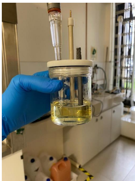
Figura 21 - Celda de trabajo de tres electrodos sumergido en solución de KI-H 2 SO 4
