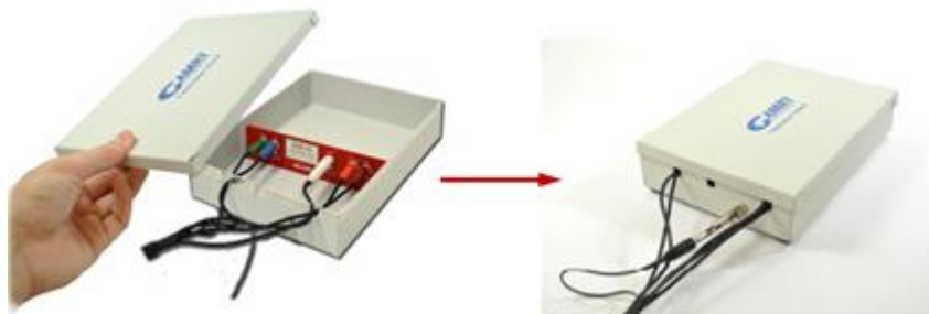
Figura 36 Imagen referencial de caja de protección con placa de calibración [29]
