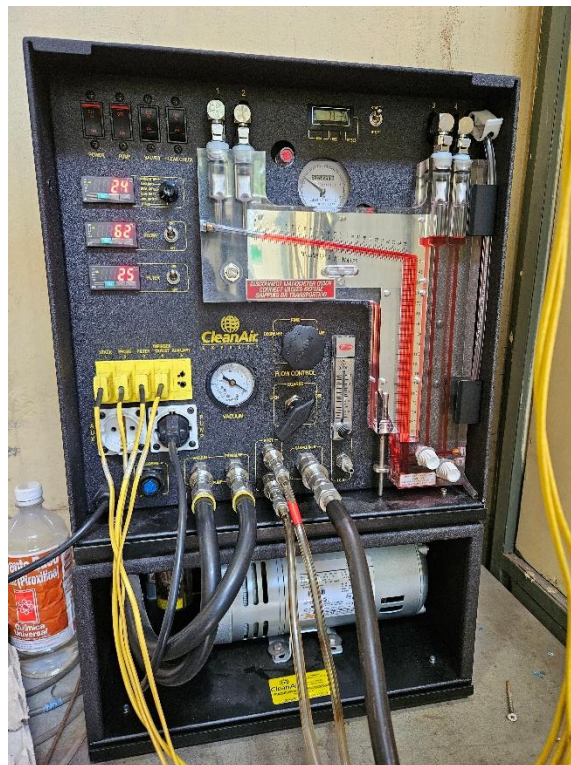
Figura 10. Unidad de control y monitoreo para el aseguramiento del isocinetismo en el tren de muestreo.
