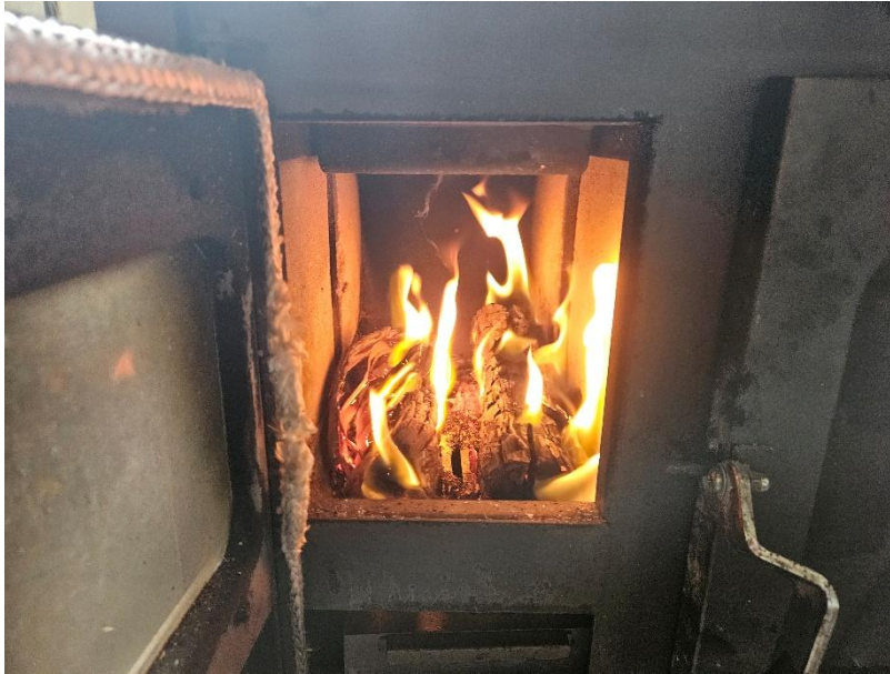
Figura 11. Estado del lecho de brasas al alcanzar el 20% de la masa residual
