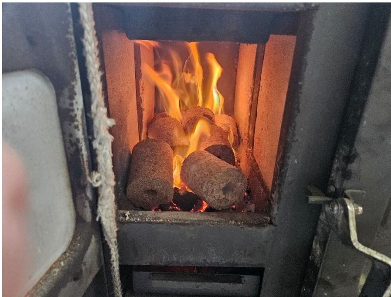
Figura 15. Registro visual del ensayo de combustión de las briquetas experimentales en la cocina Alcázar M70.
