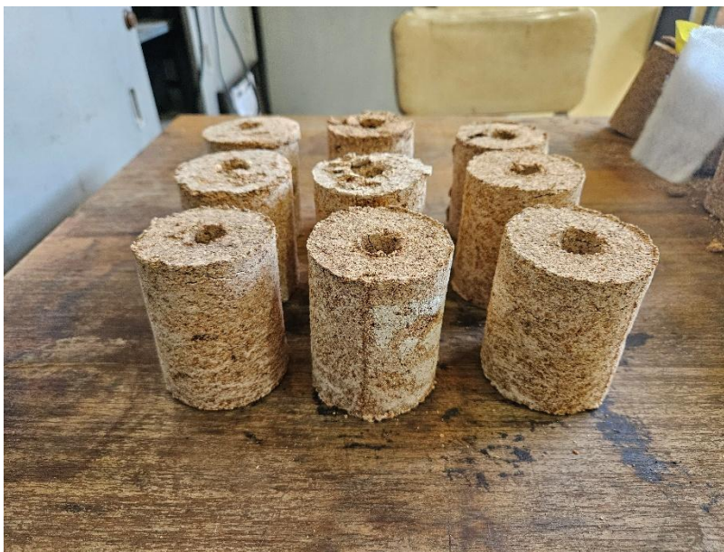
Figura 14. Muestras finales de briquetas cilíndricas huecas, fabricadas con cuercos de palta, SCG, aserrín y almidón.
