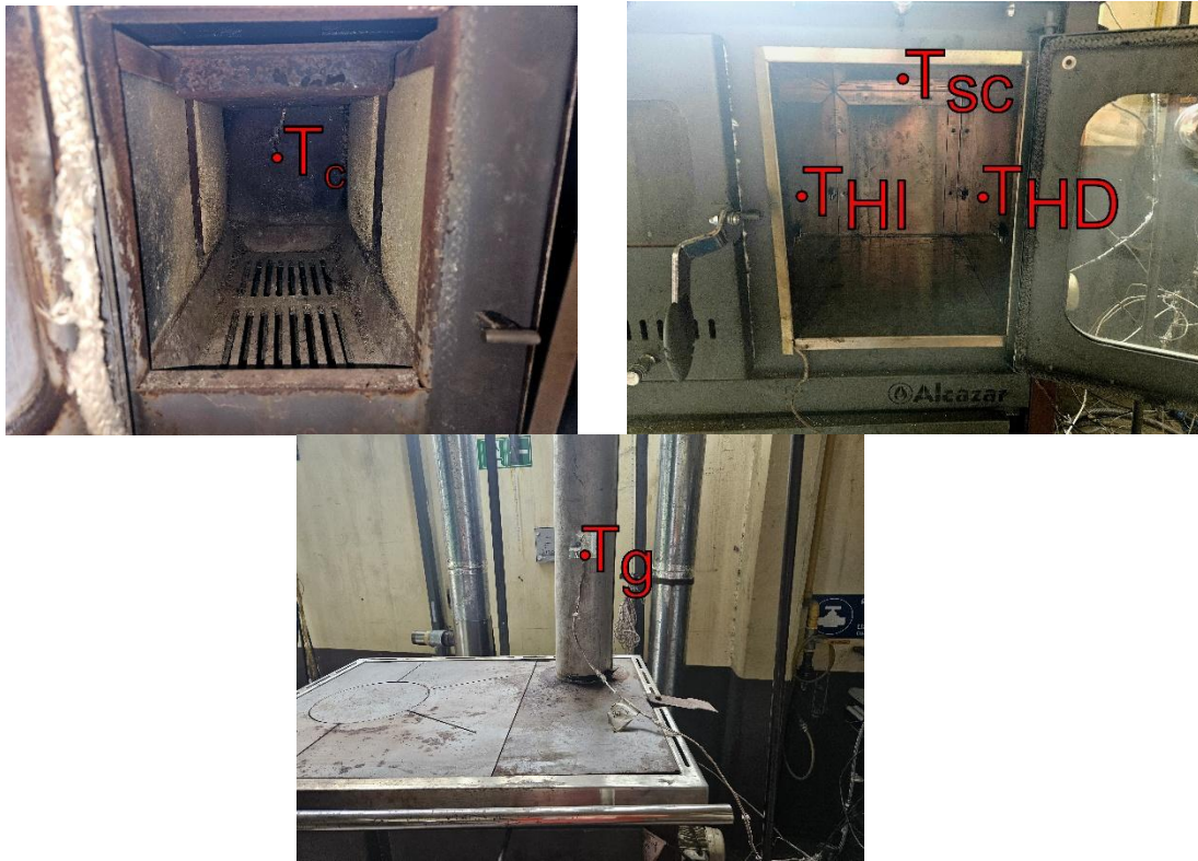
Figura 7. Ubicación de los puntos de medición de temperatura mediante termocuplas tipo K en la cocina: (a) cámara de combustión, (b) horno: lado derecho, lado izquierdo y succión del aire primario, y (c) cañón.
