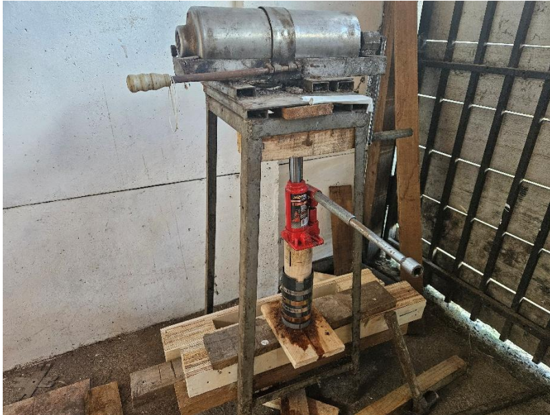
Figura 4. Conjunto de briqueteado: prensa de confección simple, molde de confinamiento en PVC con abrazaderas, mandril axial de madera y émbolo de madera torneada.
