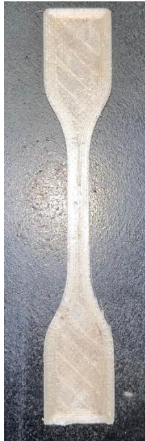
Figura 29: Probeta impresa en impresora creality ender 3 V3.
