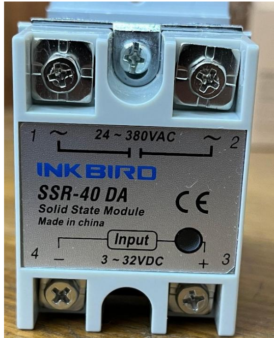
Figura 16: Relé utilizado conexión resistencia.
