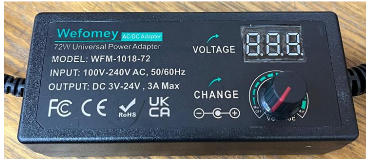
Figura 18: Fuente de poder conectada a la alimentación motor y controlador de velocidad.
