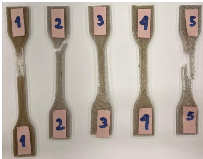
Figura 33: Probetas rPET ensayadas.
