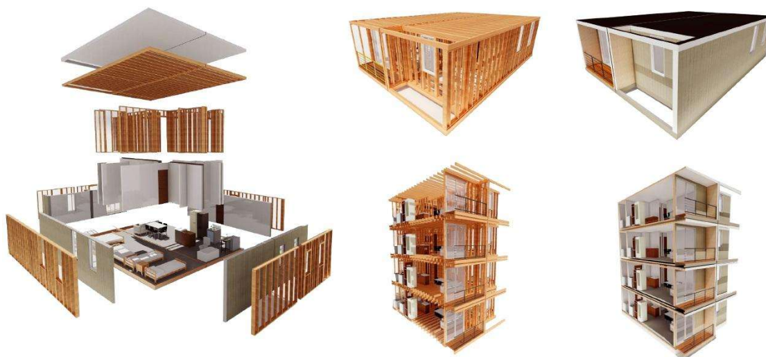
Imagen 4 - Detalle esquemático Estructura modelo BIM Proyecto Lo Espejo. Fuente: Archiplan
