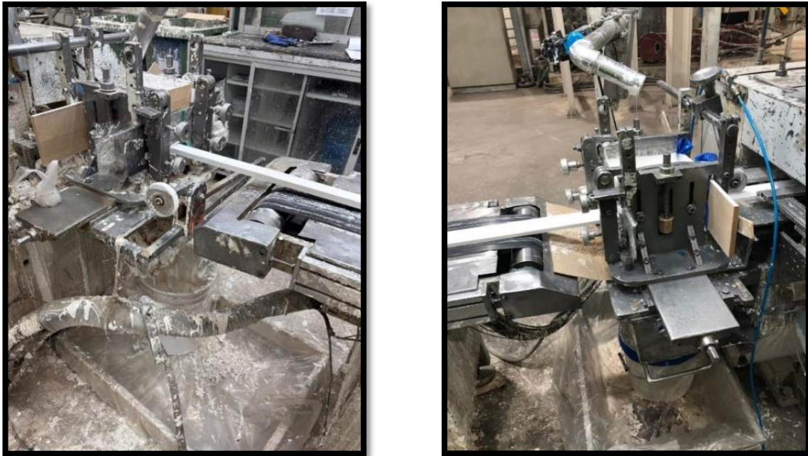
Figura 5.9: Antes y después de aplicar la rutina de limpieza en la caja de trefilado
