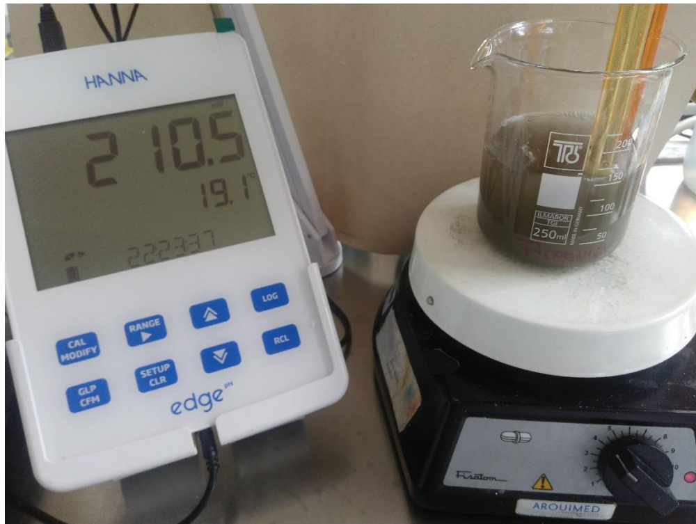
Figura 31. Etapa de acondicionamiento con control de potencial redox.
