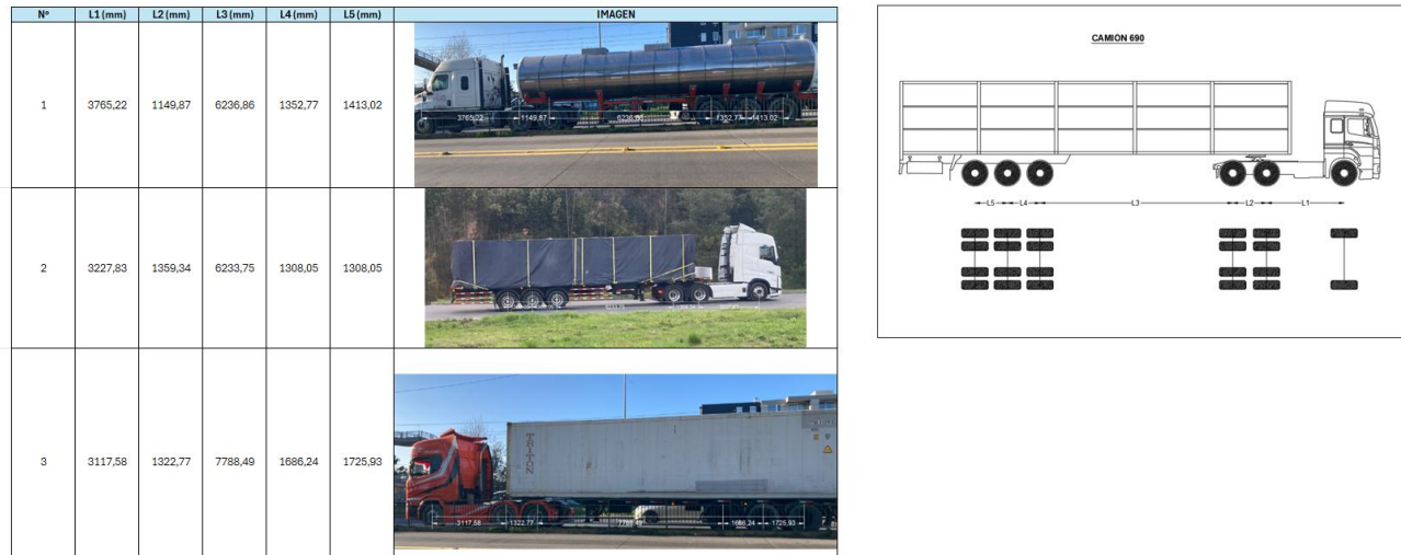
Figura 3.4 Análisis fotométrico para determinar espaciamiento entre ejes utilizando AutoCAD.
