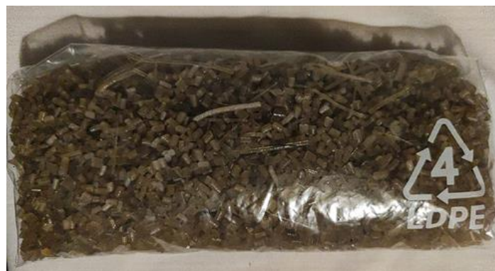
Ilustración 37. Pellet de PLA con cáñamo tratado y GMA.
