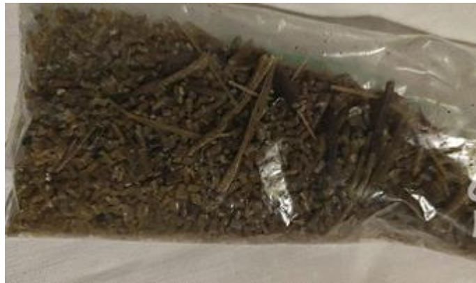
Ilustración 34. Pellet de PLA y Cáñamo al 5 %.
