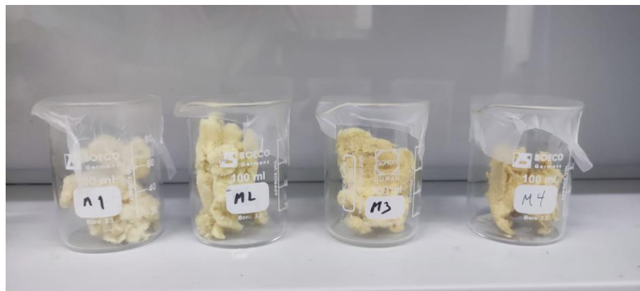
Ilustración 25. Muestras de cáñamo tratadas con EPTA.
