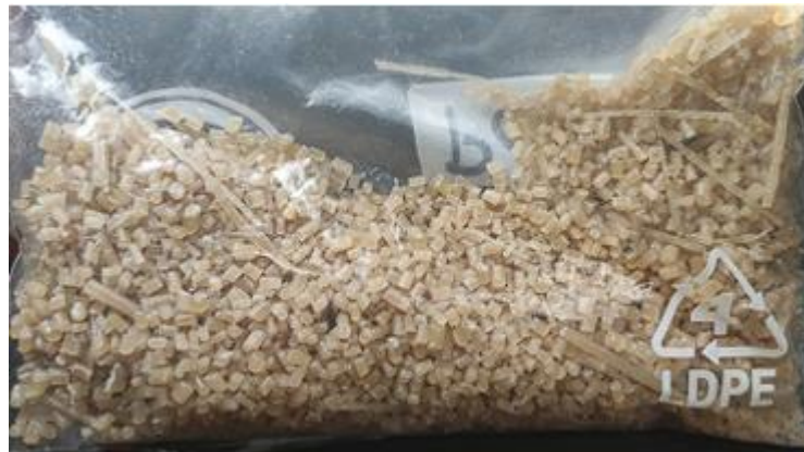
Ilustración 36. Pellet de PLA y cáñamo tratado.
