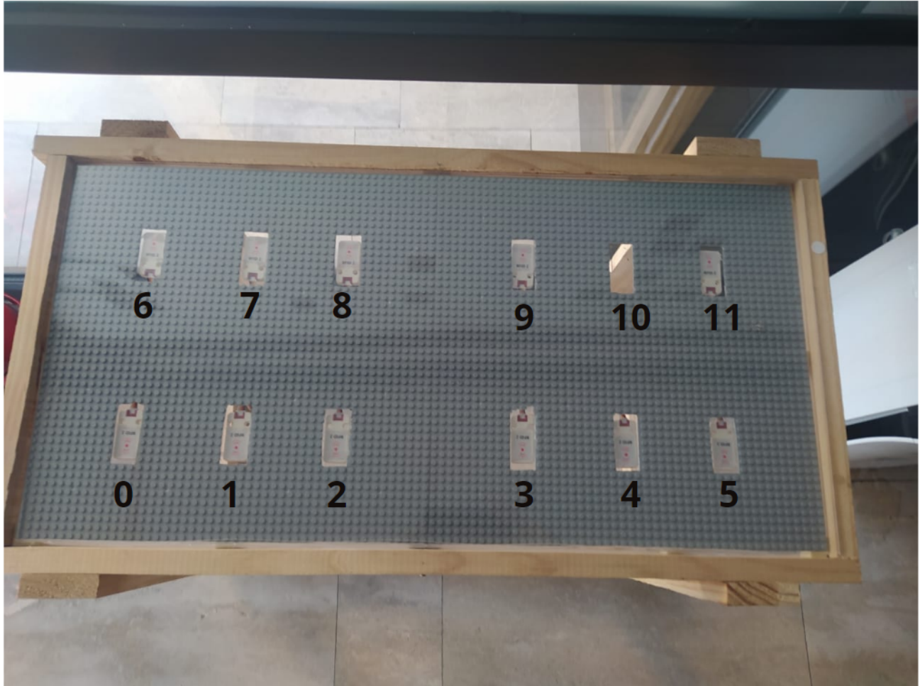
Fig. 3.15: Posición sensores RFID en la mesa con sus respectivos canales.
