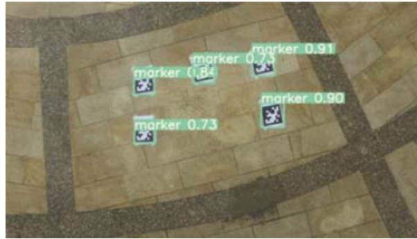
Fig. 3.3: Detección marcadores ArUco haciendo uso de Yolo.
