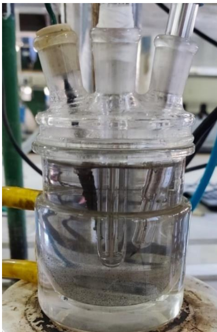
Figura 18. Te precipitado como polvo y ligero cambio en la coloración de la solución ( v=1 mV/s).
