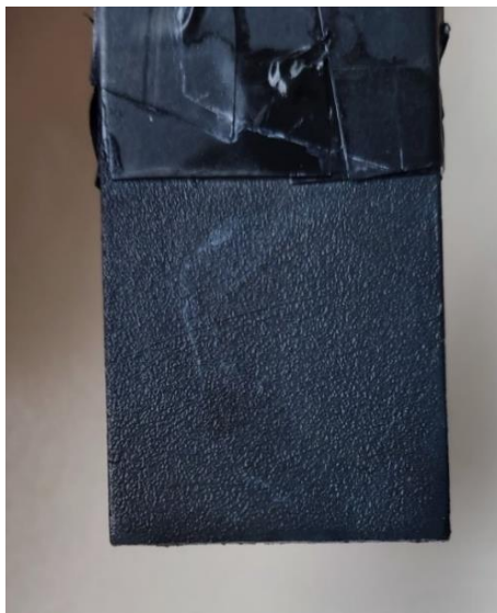
Figura 31 Telurio electrodepositado en la segunda experiencia de cronopotenciometría.
