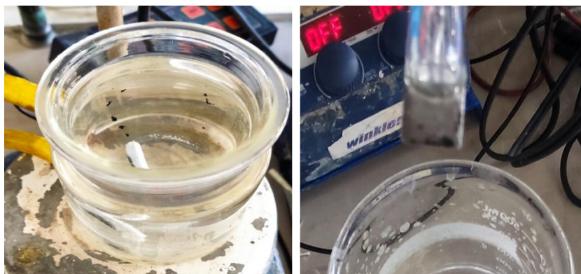
Figura 15. Presencia de telurio suspendido en la solución (izquierda) y formación de depósito poco adherente de Te sobre el electrodo de trabajo (derecha) en solución con 3g/L de Te.
