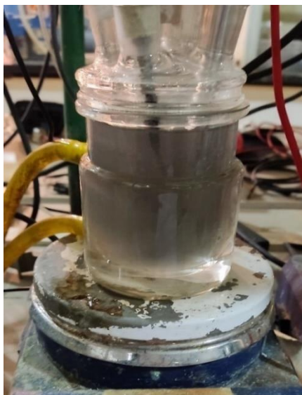
Figura 23. Cambio de color de incoloro a gris en la solución de la celda electrolítica a pH 14.4 y 5 g/L de Te en solución.
