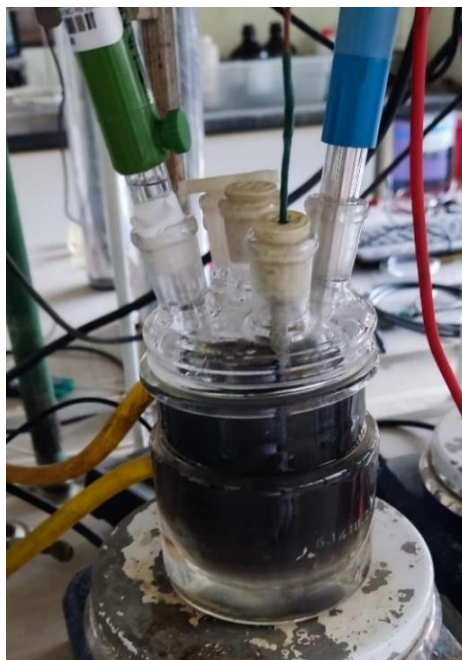
Figura 22. Cambio de color de incoloro a púrpura oscuro en la solución de la celda electrolítica a pH 14.4 y 0 g/L de Te en solución.
