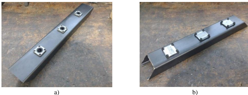
Figura 5.2.2: Perfiles horizontales. a) Superior con los rodamientos instalados. b) Inferior con las placas de los apoyos instaladas
