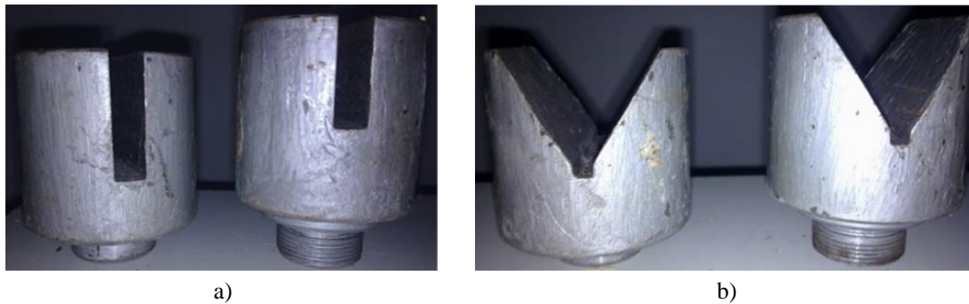
Figura 3.4.2: Dispositivos diseñados para simular las condiciones de contorno en la máquina [18]
