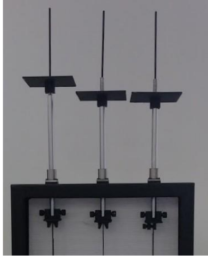
Figura 5.3.3: Sistema de transmisión de carga ensamblado e instalado en el banco de experimentos con los apoyos
