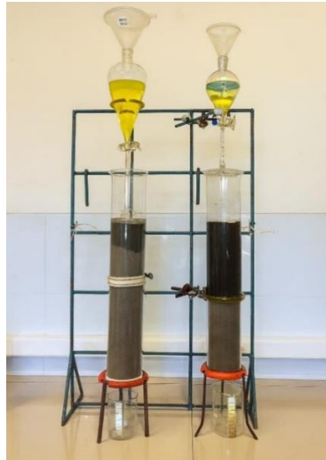
Figura 3. Montaje experimental utilizado en la simulación de la infiltración de hidrocarburos en el suelo.
