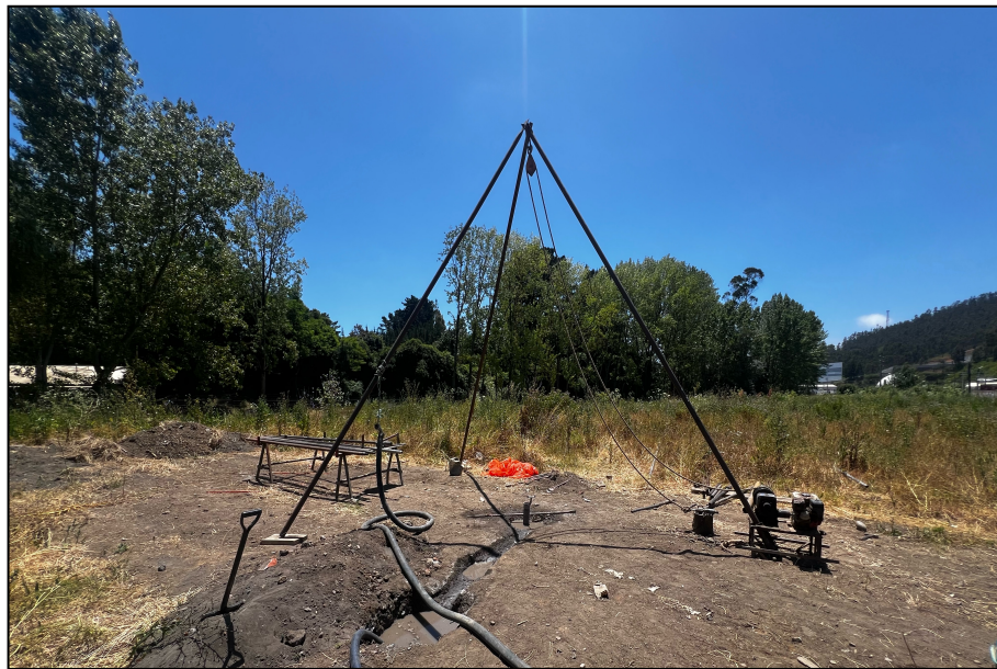
Figura 4.5 Imagen de terreno-Equipo de Sondaje por medio de Tubo Shelby
