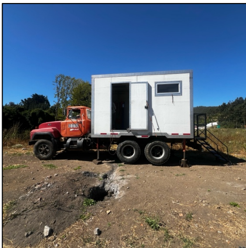
Figura 4.7 Equipo CPTu / DMT elaborado por EMPRO Ltda
