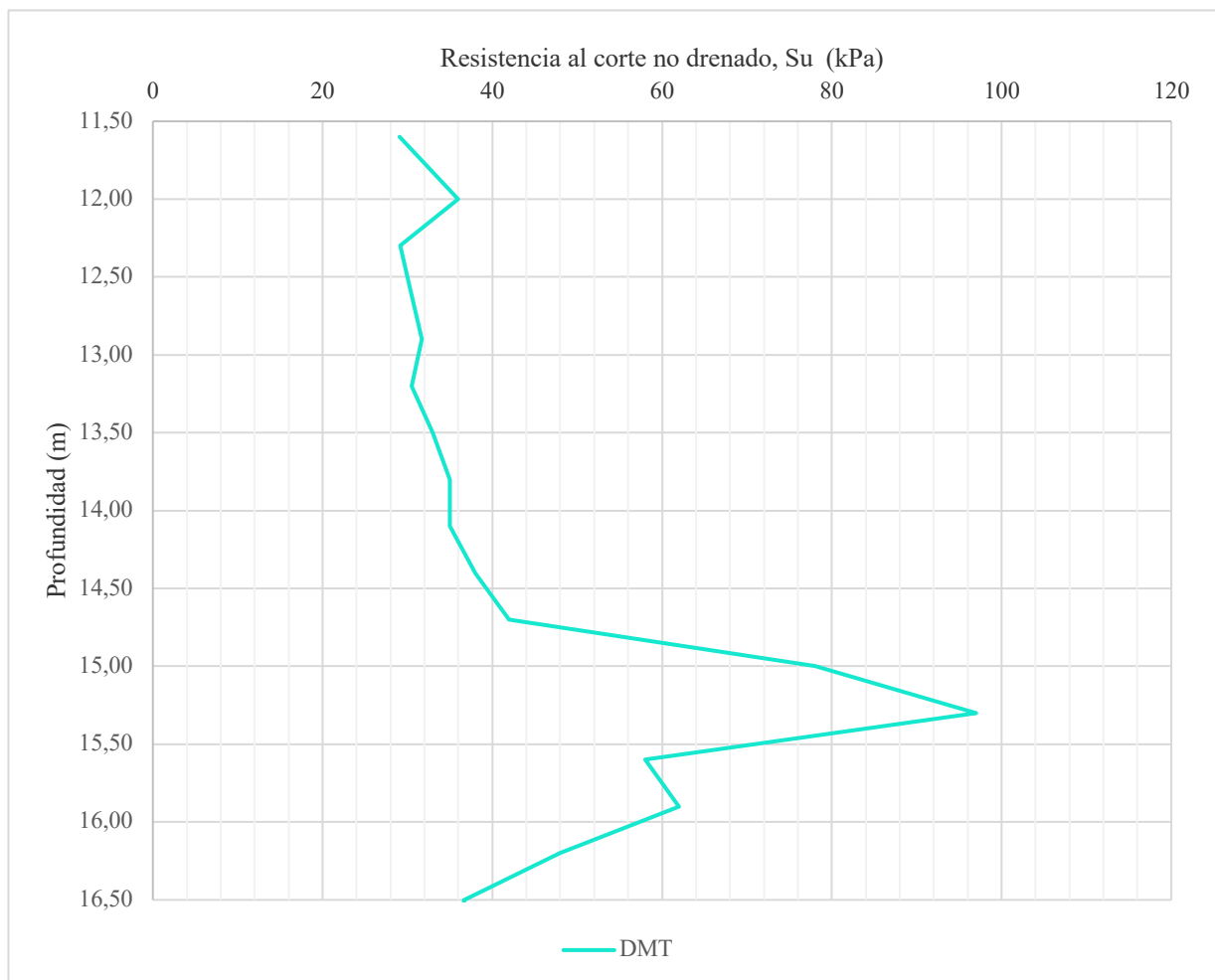
Figura 5.8 Perfil de Resistencia S_u - DMT
