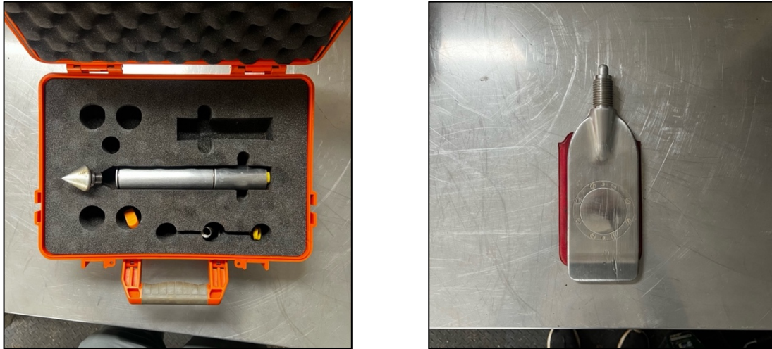
Figura 4.8 (a) Cono CPTu 10cm 2 ; (b) Paleta DMT
