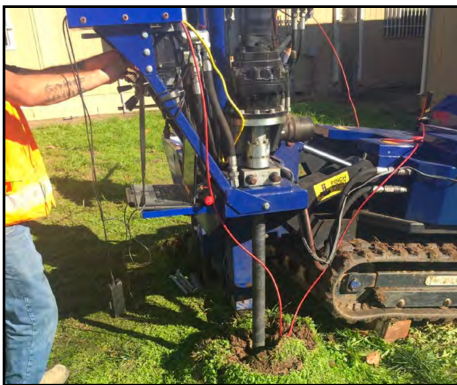
Figura 3.4 (a) Unidad de CPT anclada al suelo; (b) CPT montado en Camión de 25T
