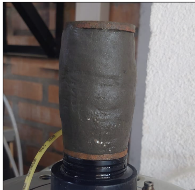
Figura 5.6 Muestra N°2 (Cota: 15,6m) Ensayo Triaxial UU
