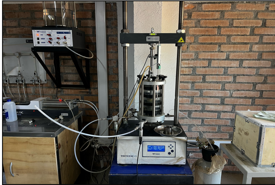
Figura 4.6 Equipo triaxial Trittech50 W/F de MSTD ingeniería
