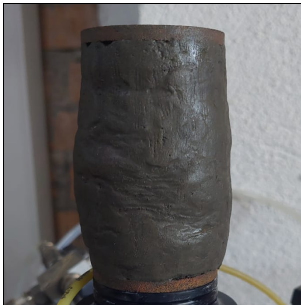
Figura 5.4 Muestra N°2 (Cota: 12,6) Ensayo Triaxial UU
