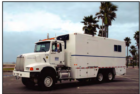
Figura 3.4 (a) Unidad de CPT anclada al suelo; (b) CPT montado en Camión de 25T
