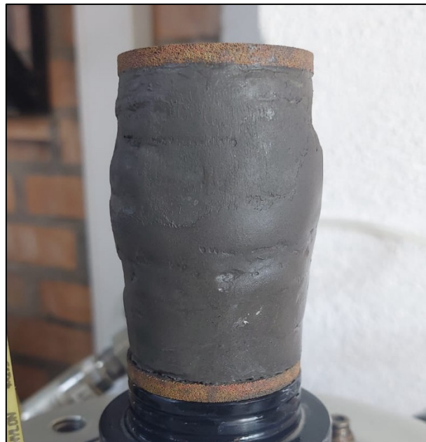
Figura 5.2 Muestra N°1 (Cota: 11,6m) Ensayo Triaxial UU
