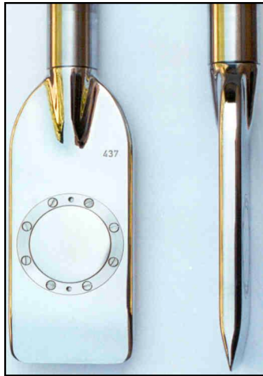
Figura 3.5 Dilatómetro Plano - Frente y Costado
