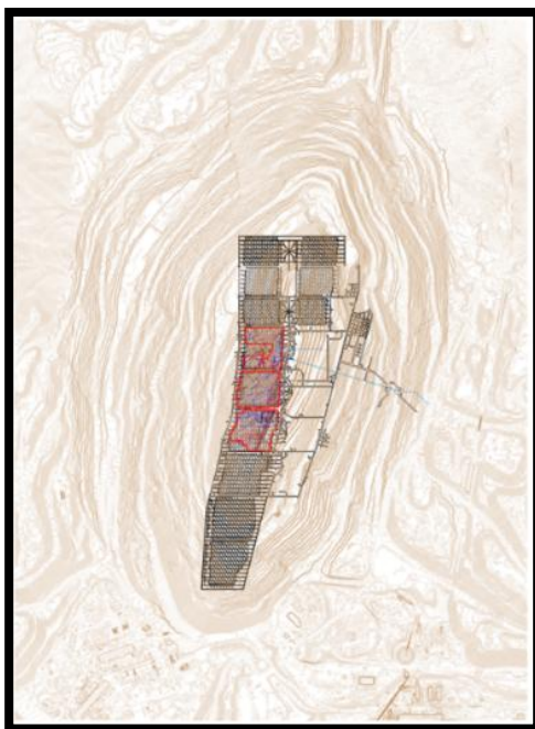
Figura 5. Vista planta proyección del rajo con el nivel productivo de mina subterránea [7].
