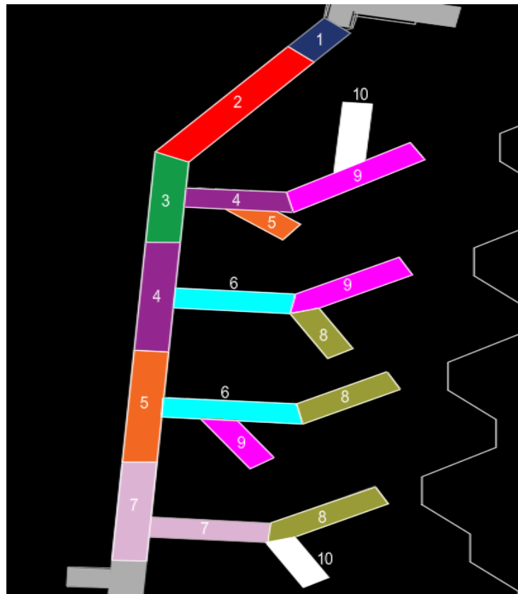
Figura 25. Orden de construcción sector Oeste MB S05 NE.
