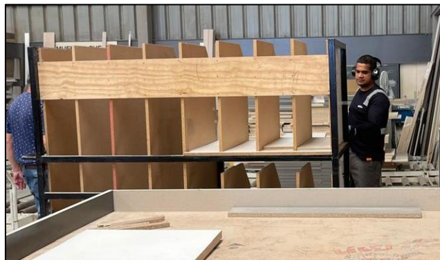
Figura 3.12: Clasificador separando piezas por mueble Fuente: Muebles Suecia
