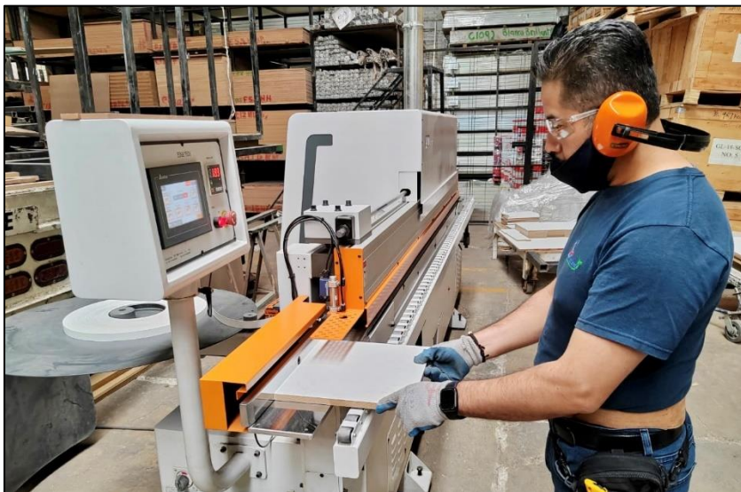
Figura 3.5: Aplicación de cubre canto a pieza
