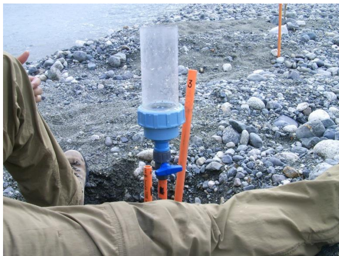
Figura 3.10 Instrumento utilizado para la prueba de infiltración.
