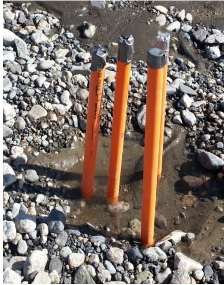
Figura 3.4 Fotografía de nido con cuatro mini-piezómetros, instalado en una de las barras del río
