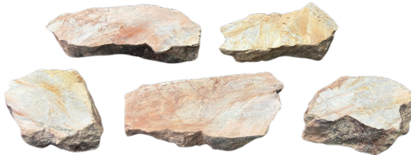
Figura 2.7 Mineral de cobre cortado en laminas de 25 mm de espesor.
