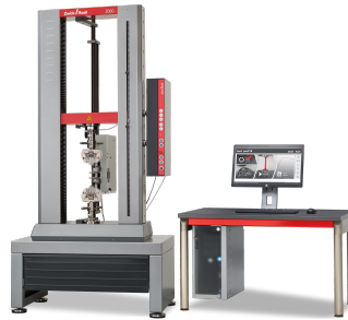
Figura 2.15 Máquina de compresión Zwick Roell modelo Z005, que está en el laboratorio de impresiones 3D de la Universidad de Concepción.
