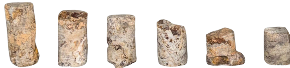
Figura 2.10 Diferentes muestras de mineral de cobre descartadas por falta de material, grietas o porosidad.
