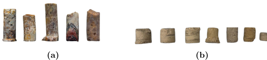
Figura 2.8 Muestras cilíndricas sin cortar. (a) Mineral de cobre. (b) Concreto.
