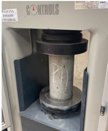
Figura A.0.2.2 Probeta en ensayo de compresión uniaxial
