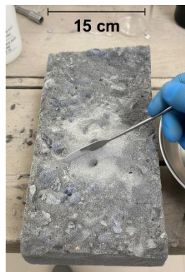
Figura 3.1 Extracción de muestra para ensayo LOI
