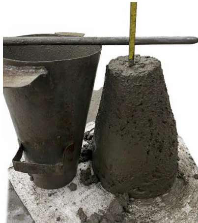
Figura A.0.2.1 Ensayo de consistencia
