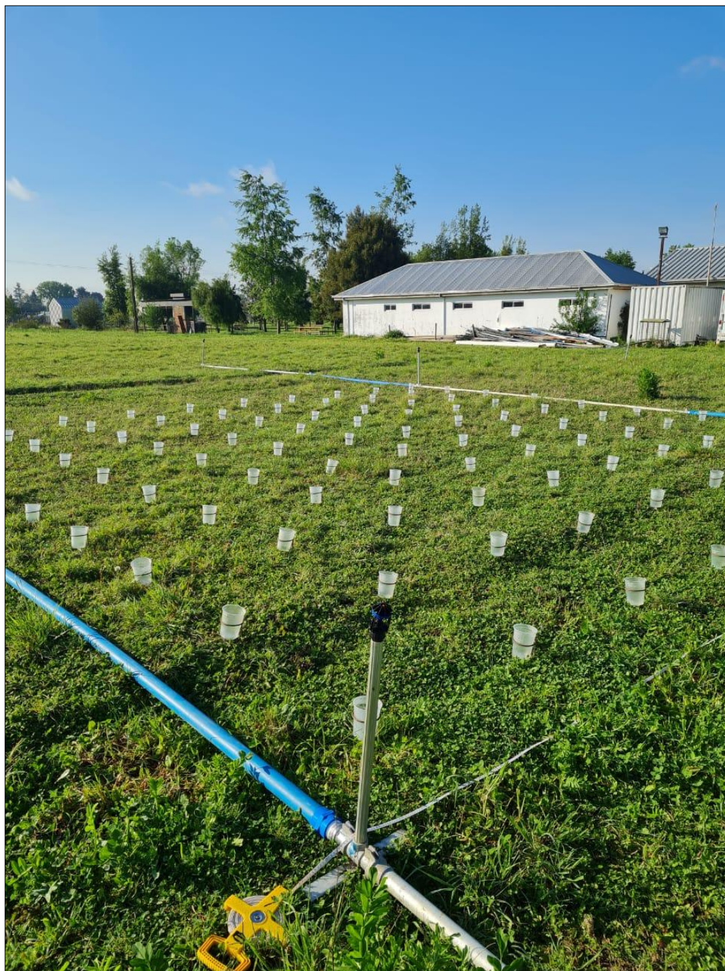
Figura 8. Prueba de uniformidad realizada en el terreno adyacente al Laboratorio de Recursos Hídricos. ( Fuente: elaboración propia )
