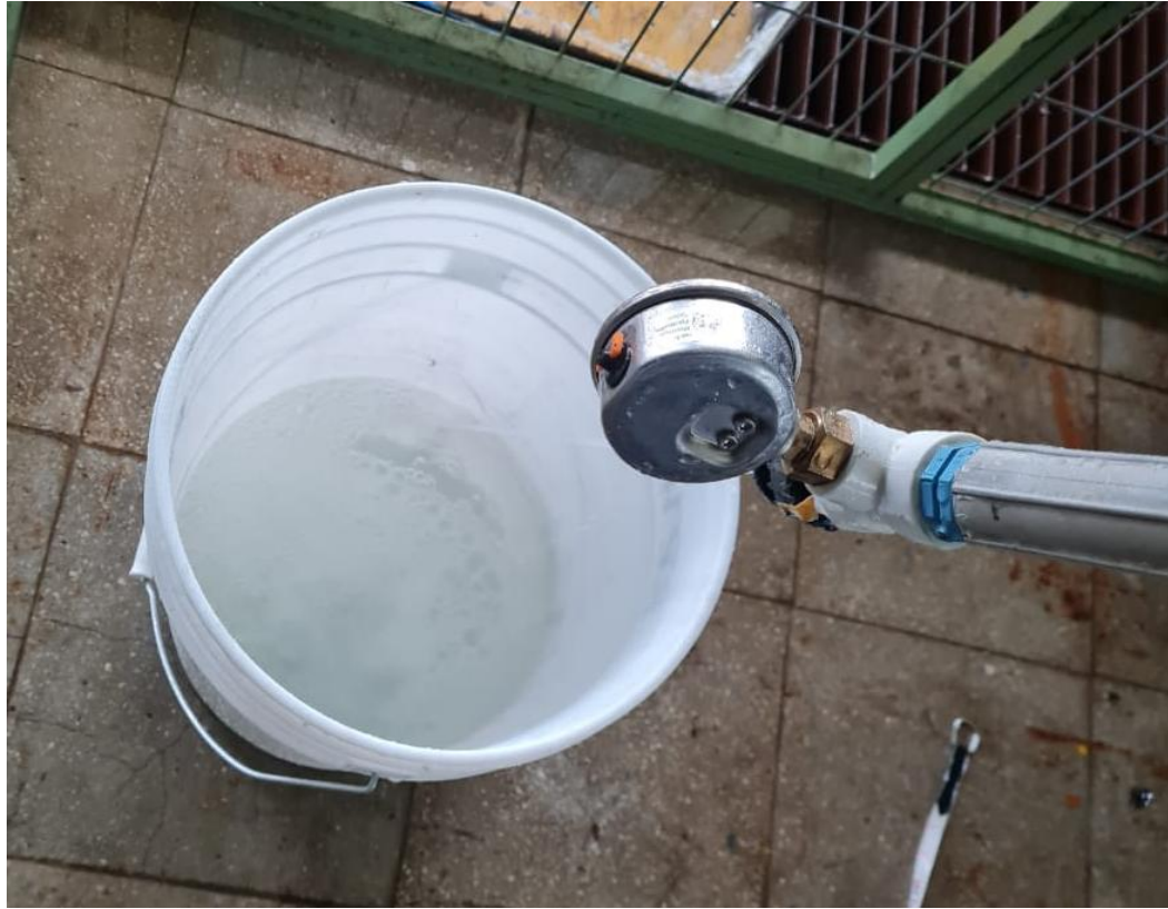
Figura 4. Medición del caudal del aspersor, en el Laboratorio de Recursos Hídricos ( Fuente: elaboración propia ).
