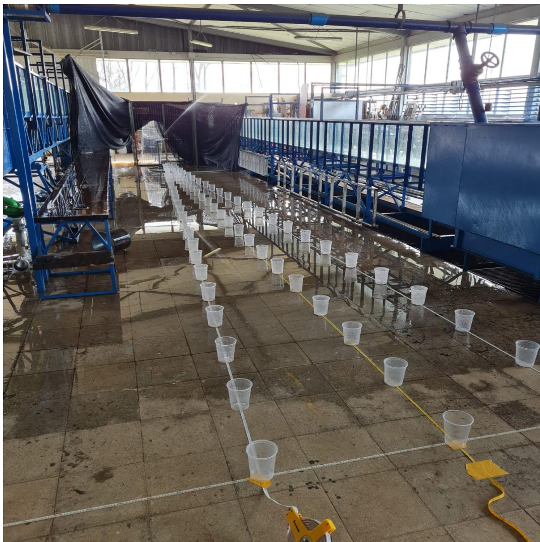
Figura 5. Obtención curva de distribución, en el Laboratorio de Recursos Hídricos ( Fuente: Elaboración Propia ).
