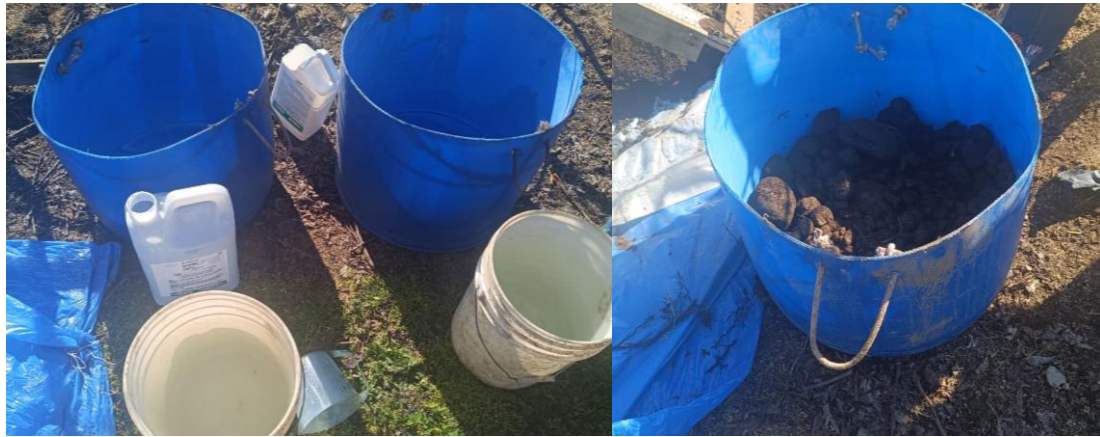
Figura 3. Determinación de Porcentaje de pedregosidad, mediante método de Arquímedes.
